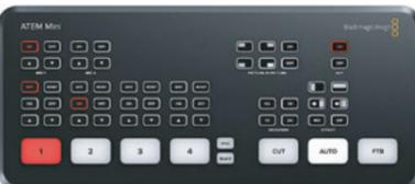
4 つの HDMI 入力を搭載し、直感的かつ使い勝手の良いデザイン。YouTube や Facebook Live、Skype などのサービス/ソフトウェアを介して、誰でもマルチカムプロダクションをライブ配信できます。4 つの高品質 HDMI 入力を接続するだけで、カメラ、コンピューター、ゲーム機などのライブスイッチングが可能。エキサイティングなビジュアル・イン・ビジュアル・エフェクト用の内蔵 DVE、放送品質のトランジション、グリーンバック用のアップストリームキーヤー、グラフィックをスーパーインポーズできるダウンストリームキーヤー、オーディオミキサーなどにも対応。
