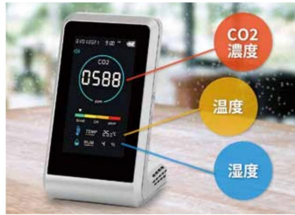
ウイルス対策に必要な換気ですが、頻りに換気すると室内の温湿環境が不安定になり快適性が懸念されます。CO2モニターは室内の二酸化炭素濃度、温度、湿度の3つをモニタに表示し、換気のタイミングを見える化します。
