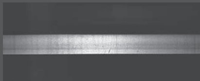
▲ 覗き窓から見たスペクトル。 縦に走っている線がブラウンホーファー線
