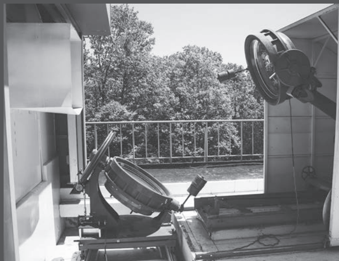
▲ 2枚の鏡で構成されるシーロスタット。 左下の鏡が太陽からの光を受けている
