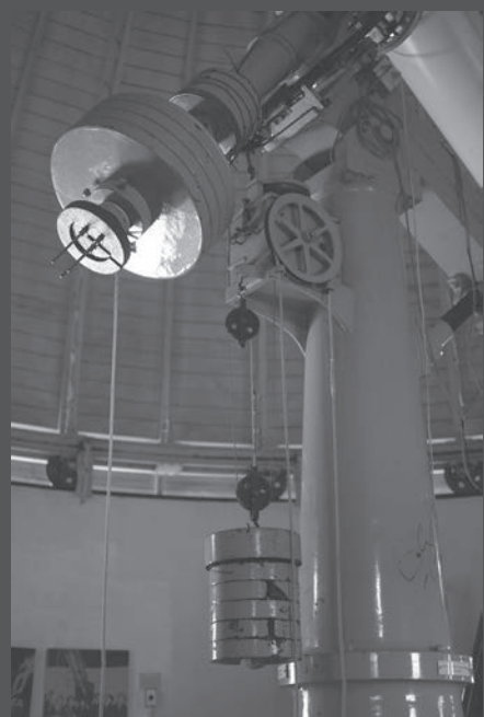
▲ 垂れ下がっている円筒形の物がおもり。その上の四角い箱とセットで機能している
