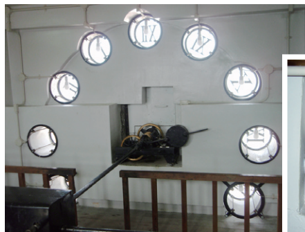
▲文字盤裏。1分に1度、音を立てて針が動く様子を間近で見られる。また、時計台の魅力のひとつである文字盤のイルミネーションは、意外とシンプルなものであった(右写真)。
